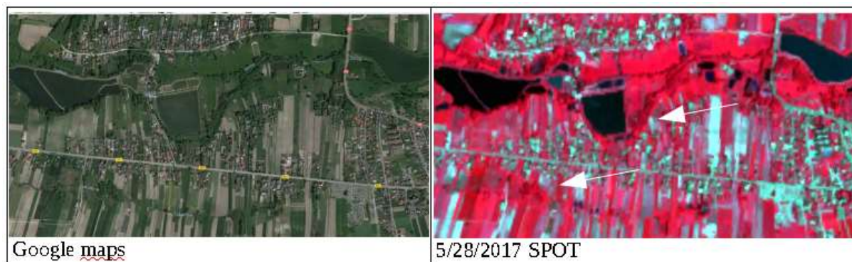
Rysunek 30 S19 - 857 Modliborzyce – Słupie, widoczne na FCC nadmierne uwilgotnienie (z prawej), porównanie na RGB (z lewej)
