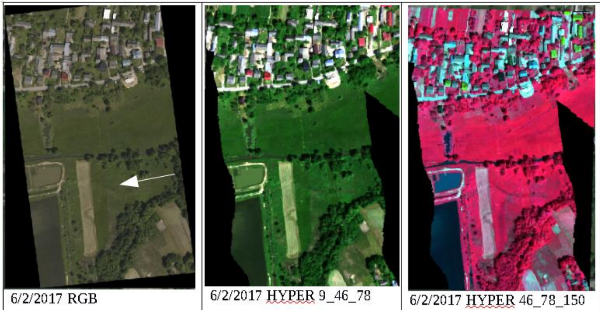
Rysunek 31 S19 Polichna Pierwsza – ode lewej: RGB FOTO, kompozycje z obrazów hiperspektralnych RGB i FCC, analiza obszarów nadmiernie uwilgotnionych
